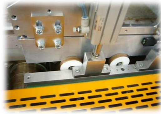
( RoboClean in fase di avanzamento sui rulli del forno )
