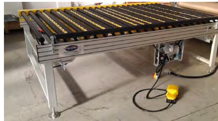
RULLIERA DI SCARICO LINEA /USCITA ESSICCATOIO
