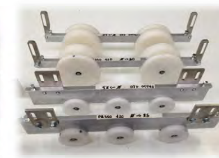
(dispositivo de cambio de paso de rodillos para gestionar diferente pasos y diferente diámetro rodillos)
