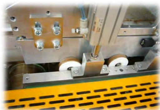
( CRR in fase di avanzamento sui rulli del forno )
