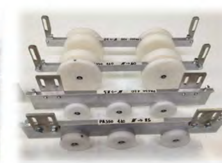
( Kit cambio passo per gestire passi diversi e diametro rulli diversi )
